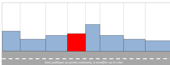
■ Implantation de la nouvelle construction à l'alignement
